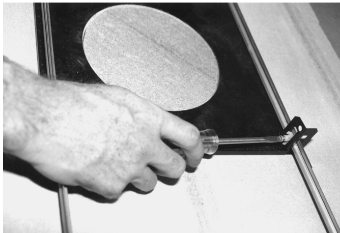
Obrázek 4.4 Utažení zajišťovacího šroubu výztuhy
